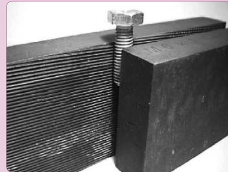
Roulage d'une vis à tête hexagonale par peignes rectilignes
