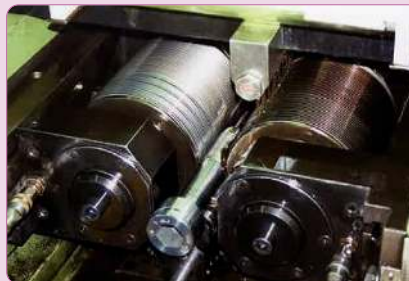
3.7-3 Roulage en plongée d'une vis à six pans creux
