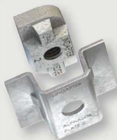
Le Type AW – Alphawdge, comme la plupart des Fixations sous Planchers Collaborant de Lindapter, se fixe dans la rainure en queue d'aronde de la structure métallique des planchers. Dans ce projet, la tuyauterie, la ventilation et le système d'éclairage ont été suspendus sous la structure métallique. Lindapter propose une gamme de fixations pour suspentes compatibles avec la majorité des fabricants britanniques, y compris CMF®, Tata Steel®, Kingspan®, SMD® et Hare Decking.
