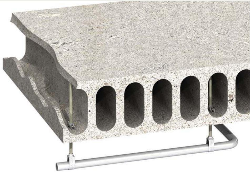
L'écrou rotule est conçu pour la suspension des conduites générales à partir de dalles creuses de béton pré-moulé (profondeur minimum 75 mm) et aussi à partir de profilés creux, de tôles d'acier ou de pannes.
