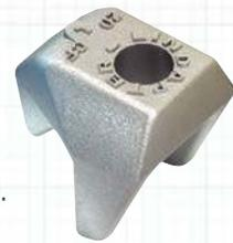
Les crapauds d'assemblage Type CF haute résistance au glissement s'accrochent sur la tranche de l'aile de la poutre. Un œilleton sert à relier le câble de suspension au crapaud. Le cadre support est ensuite relié au câble pour soutenir le chemin de câbles.
