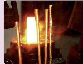
3.1-1 Chauffage du lopin
