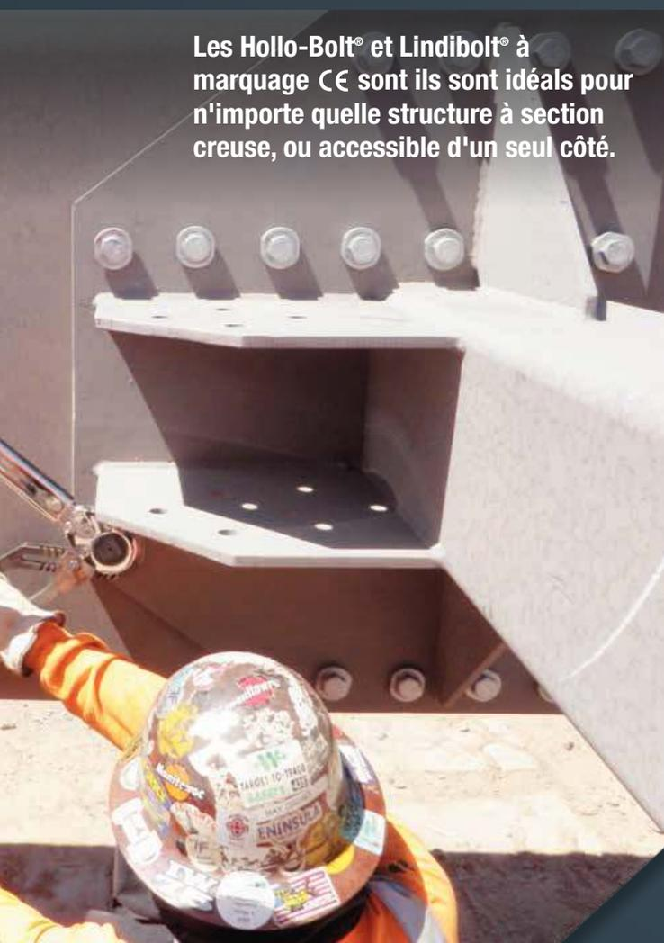
Les boulons expansibles Lindapter éliminent le recours au boulonnage traversant conventionnel ou à la soudure; l'installation se fait rapidement et en toute sécurité en insérant le produit dans des orifices percés à l'avance, puis par serrage au couple recommandé en utilisant exclusivement des outils à main.
