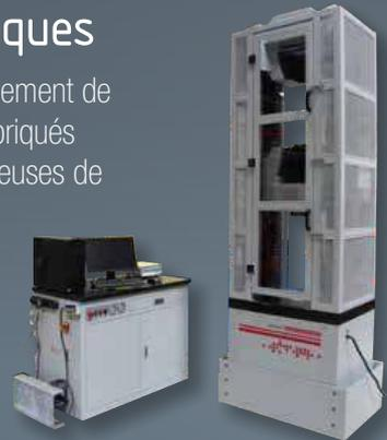
*(ci-dessus)* L'une des deux plateformes d'essais d'une capacité de 1000 kN dans le département R&D de Lindapter
