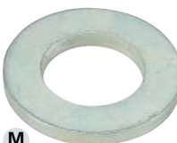
70201 Rondelle plate normale Grade A Normes ISO 7089 Matériau Acier 200HV Revêt. Zn
