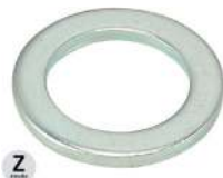
70256 Rondelle plate étroite Grade A Normes ISO 7092 Matériau Acier 200HV Revêt. Zn 200 HBS
