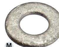
70204 Rondelle plate normale Grade A Normes ISO 7089 Matériau Acier 200HV Revêt. Galvanisé à chaud
