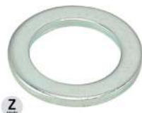
70251 Rondelle plate étroite Grade A Normes ISO 7092 Matériau Acier 200HV Revêt. Zn
