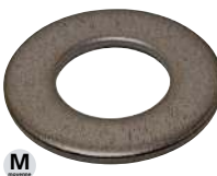
70200 Rondelle plate normale Grade A Normes ISO 7089 Matériau Acier 200HV Revêt. Brut
