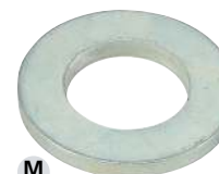
70206 Rondelle plate normale Grade A Normes ISO 7089 Matériau Acier 200HV Revêt. Zn 200 HBS
