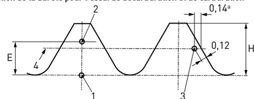
Pas de décarburation lorsque HV(2) ≥ HV(1) - 30
