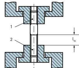
Figure c - Exemple de dispositif d'essai pour goujons
