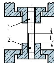
Figure c - Exemple de dispositif d'essai pour les goujons
