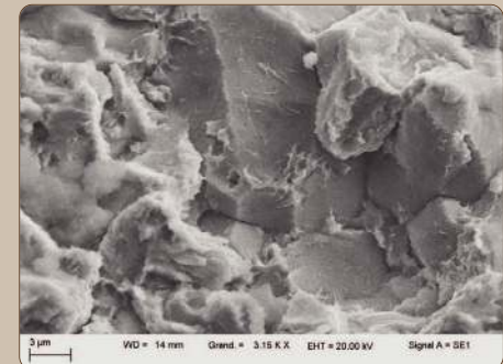
7.4-4 Détail- observation de microporosités et de vermicules en surface des grains
