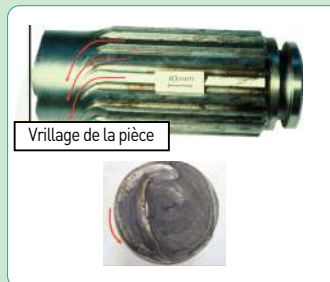
5.6-3 Rupture par sollicitation excessive de torsion
