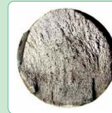
5.6-6 Rupture due à une fragilisation par l'hydrogène
