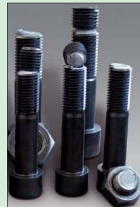
5.55-8 Echantillons après un test de fatigue
