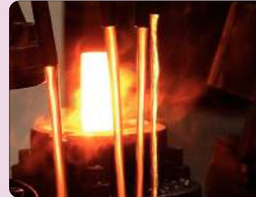
3.1-1 Chauffage du lopin
