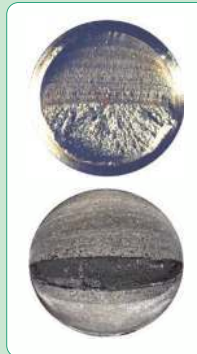
5.6-5 Ruptures par flexion plane et par flexion alternée
