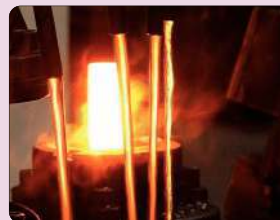
3.1-1 Chauffage du lopin
