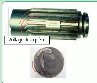
5.6-3 Rupture par sollicitation excessive de torsion
