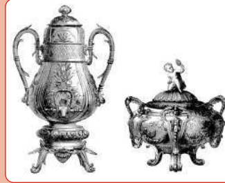
Reproduction d'objets d'art par procédé de galvanoplastie.
