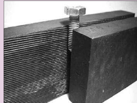
Roulage d'une vis à tête hexagonale par peignes rectiligne
