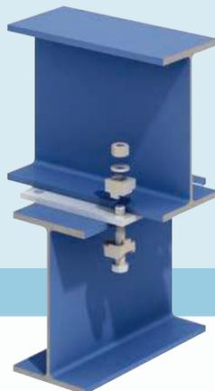
3) À l'aide d'une clé dynamométrique, serrer les boulons tour à tour au couple spécifié.
