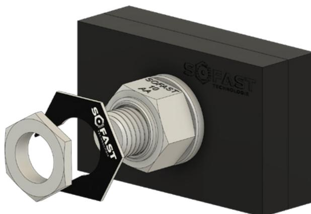
La tension souhaitée est atteinte lorsque le fusible de l'écrou se rompt pendant la phase de serrage du boulon RCI SOFAST Technologie.
